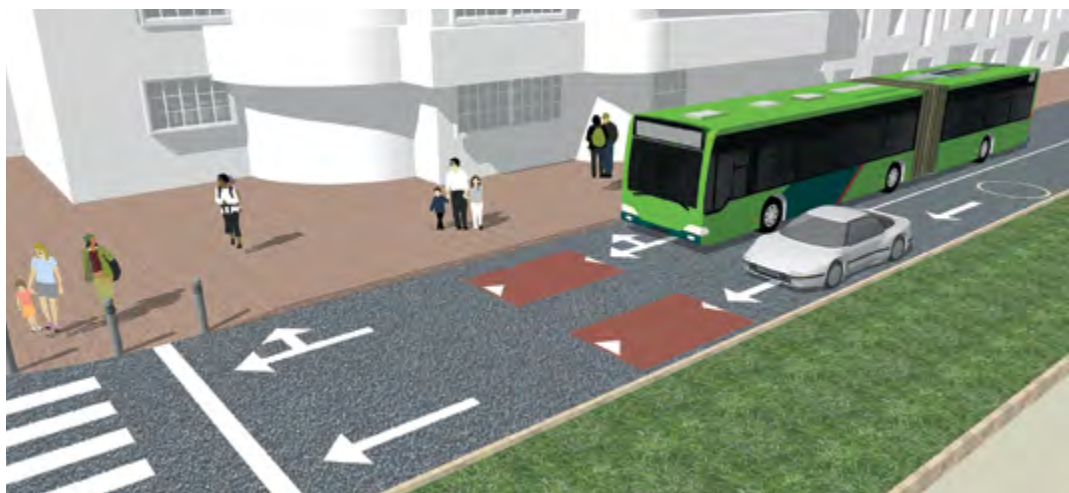
Almofadas atenuadoras de velocidade podem permitir que veículos de eixos largos passem sobre a almofada, melhorando o conforto dos passageiros de ônibus
