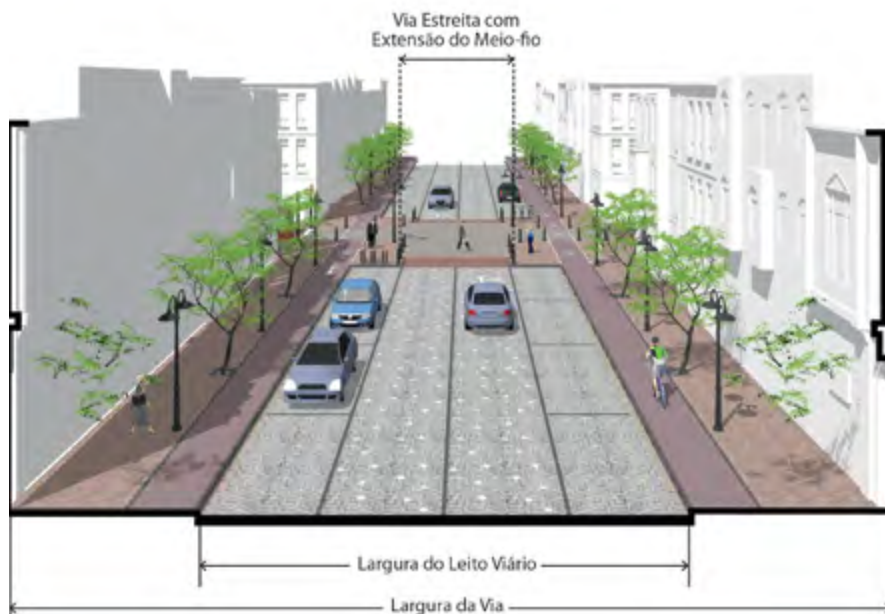
Ilustração mostrando os diferentes aspectos da largura da via
