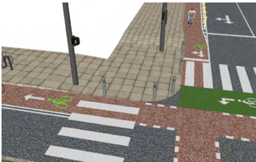
A interseção acima apresenta boas práticas para melhorar a visibilidade do ciclista: faixa de retenção avançada e bike box para conversão
